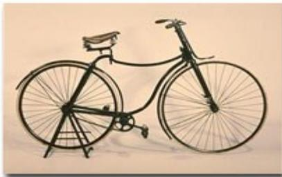
En 1884, plusieurs fabricants – Humber, McCammon, ainsi que J. K. Starley and Sutton – produisirent des bicyclettes ayant des profils plus longs et plus bas que le modèle ordinaire et dotées d'une transmission par chaîne continue sur la roue arrière.
