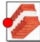
Les briques composites avec une plaque de polystyrène prise en sandwich
