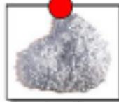
Le polystyrène expansé 98% d'air et 2% de matière
