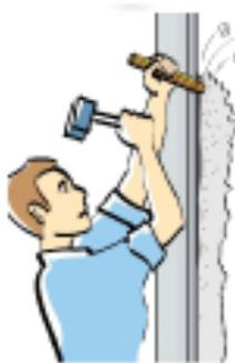
Saignée pratiquée dans le mur avant la pose d'un cloison.
