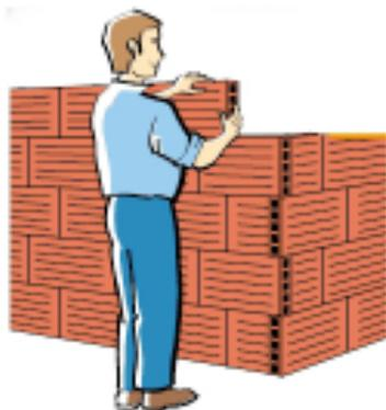
Réalisation d'un cloison dite «humide» en brique plâtrière.
