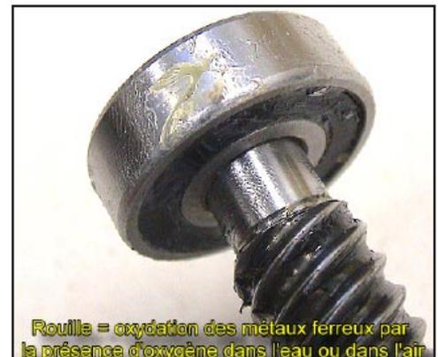
Rouille = oxydation des métaux ferreux par la présence d'oxygène dans l'eau ou dans l'air
