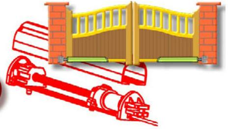
Les vérins possèdent un moto-réducteur. C'est un moteur électrique équipé d'une petite boîte de vitesses qui permet d'obtenir une rotation très lente en sortie et une force importante, on dit un «couple».
