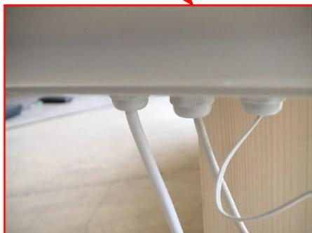
Passez les câbles des 2 vérins et du feu clignotant dans les passages de fils sous boîtier.
